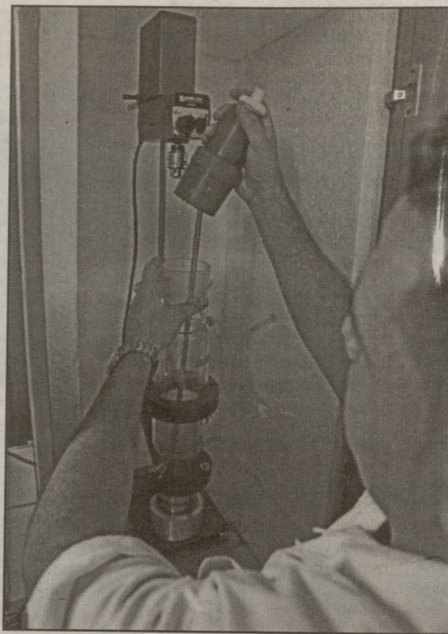
Michel Manduca, licenciado en Radioquímica, desmonta del reactor ultrasónico una muestra para medir la degradación de un fármaco.
